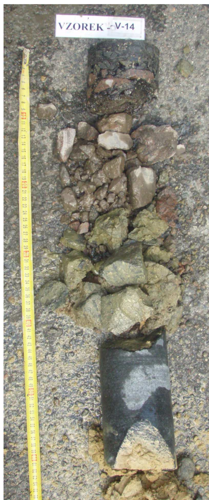
Obr. 27 - Jádro vývrtu Vzorek – V14 (in situ).
