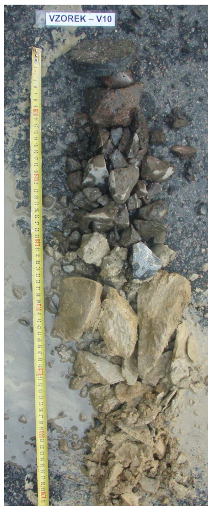
Obr. 19 - Jádro vývrtu Vzorek – V10 (in situ).
