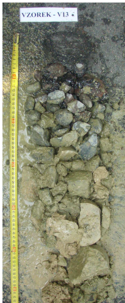
Obr. 25 - Jádro vývrtu Vzorek – V13 (in situ).
