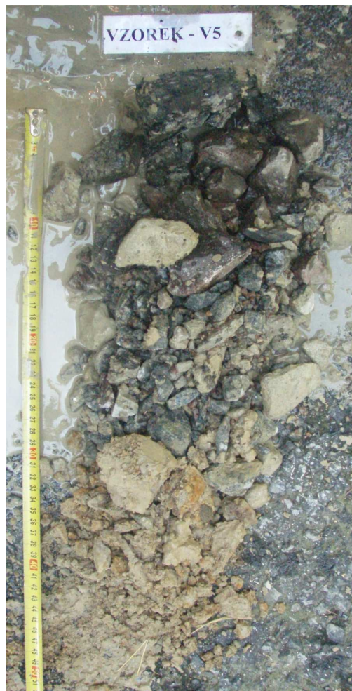
Obr. 9 - Jádro vývrtu Vzorek – V5 (in situ).
