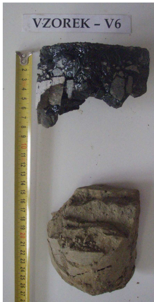
Obr. 12 - Jádro vývrtu Vzorek – V6 (laboratoř).
