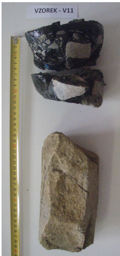
Obr. 22 - Jádru vývrtu Vzorek – V11 (laboratoř).
