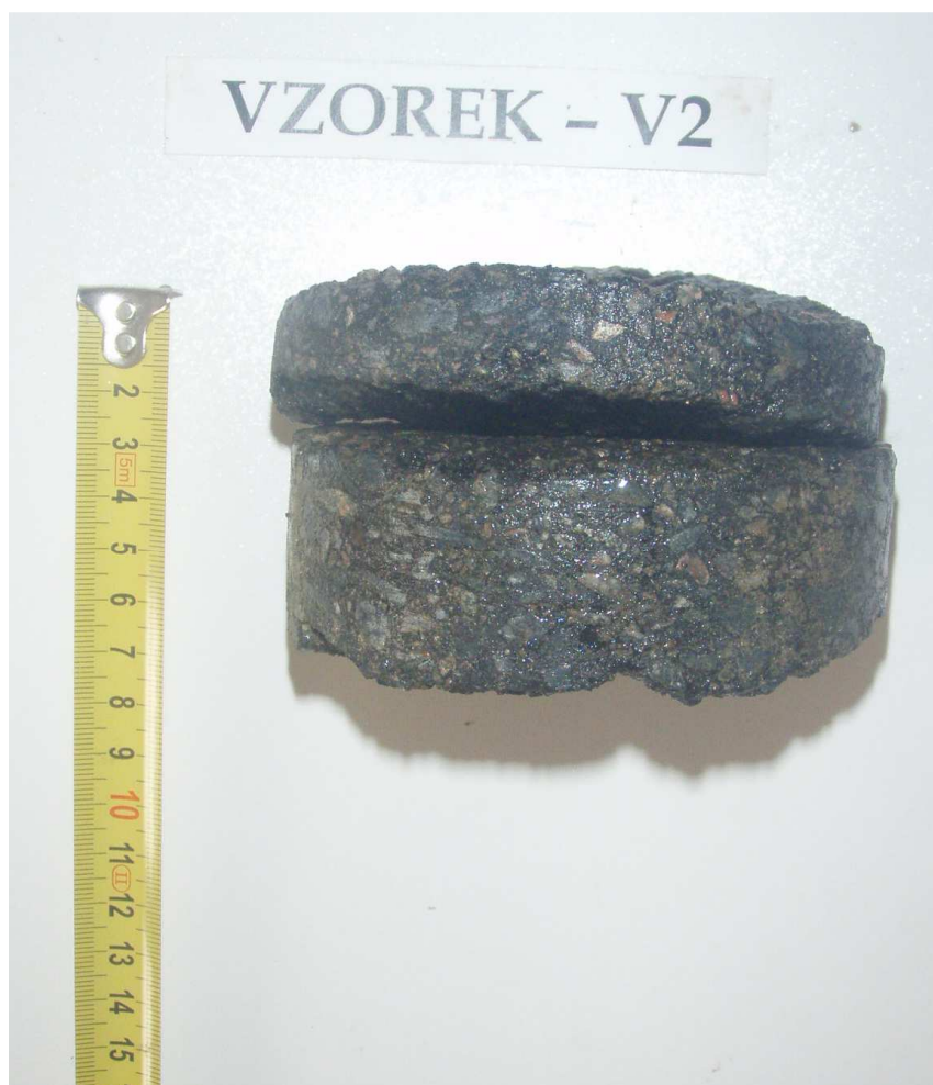
Obr. 4 - Jádru vývrtu Vzorek – V2 (laboratoř).
