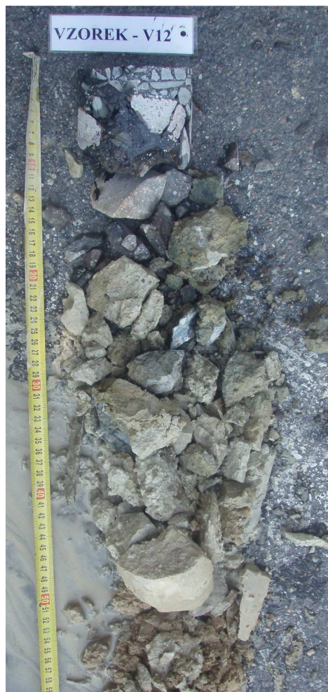
Obr. 23 - Jádro vývrtu Vzorek – V12 (in situ).
