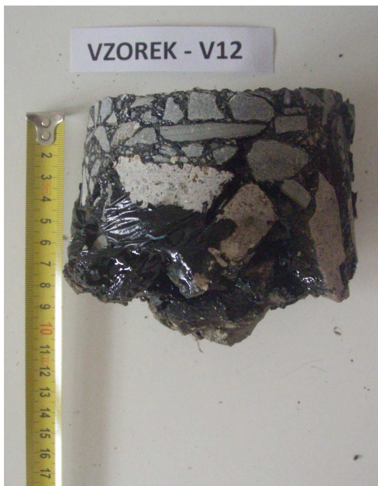
Obr. 24 - Jádro vývrtu Vzorek – V12 (laboratoř).
