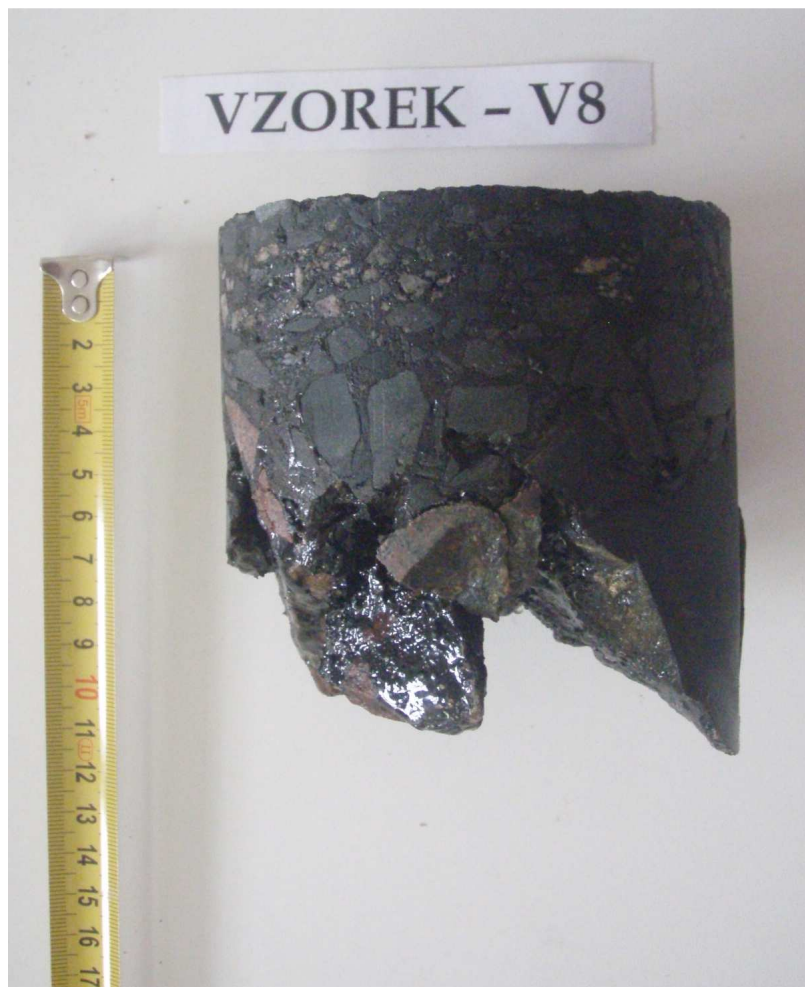
Obr. 16 - Jádro vývrtu Vzorek – V8 (laboratoř).
