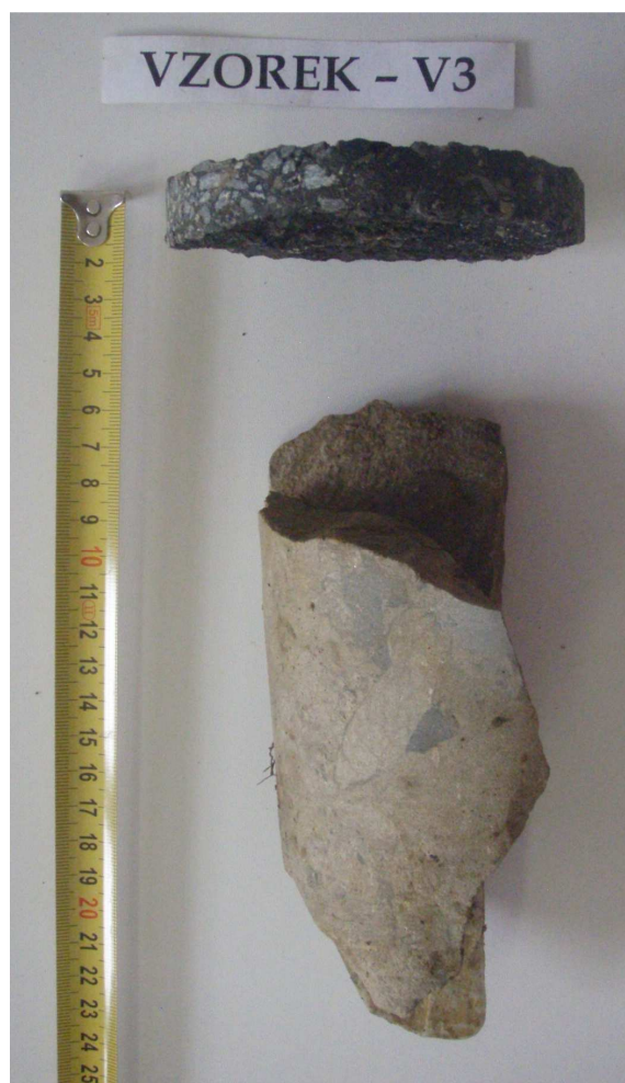
Obr. 6 - Jádro vývrtu Vzorek – V3 (laboratoř).
